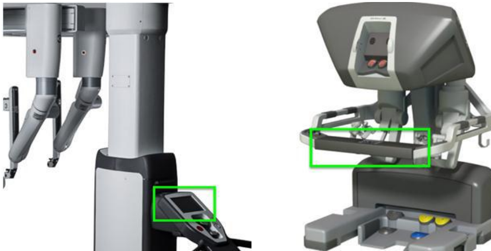
Figura 1. Localização do Touchpads no Cartão Lateral do Paciente da Vinci Xi (Esquerdo) e Console do Cirurgião da Vinci Xi e Si (Direito).
