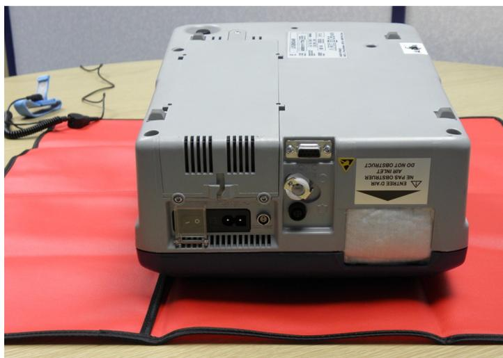
4. Utilizando um TT10 Torx remova os 02 ou 03 parafusos de segurança da porta da bateria:
