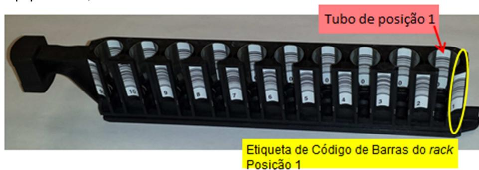
2. Durante a remoção deste *rack* de amostra contendo amostra A, a etiqueta do código de barras do *rack* indicando a posição 1 (ver imagem acima) não
