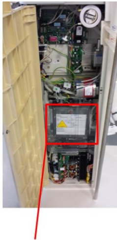
Tampa de proteção de plástico na frente do medidor de fluxo de massa (IB 1426100)
