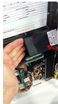
Bateria de chumbo reclinada para realizar a extração da PSU
