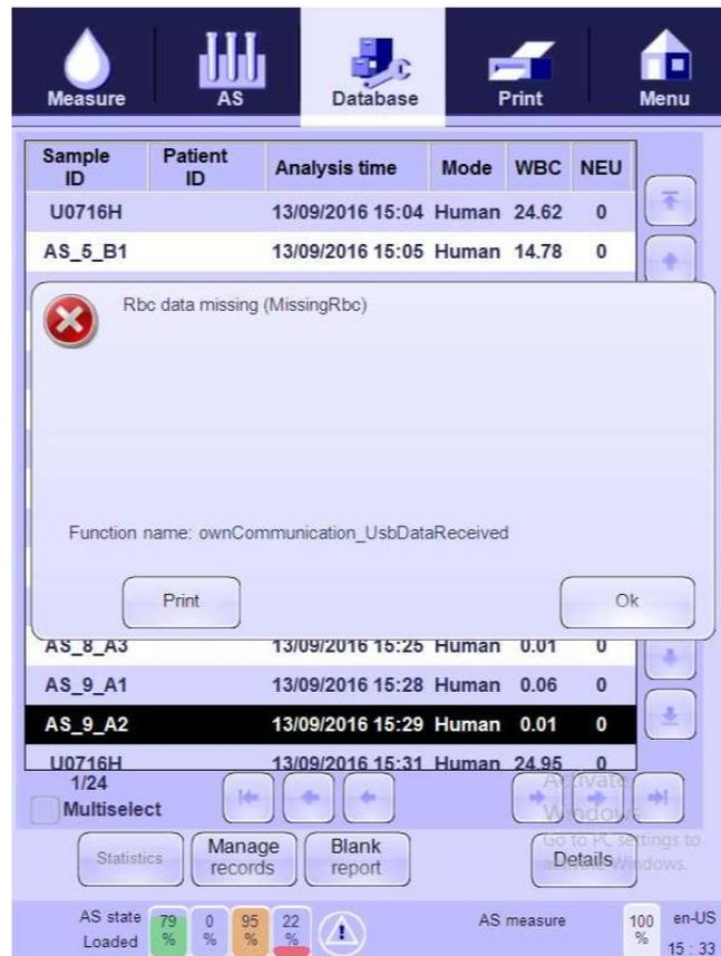
No modo manual de operação do sistema, a mensagem deverá ser clarificada para a continuidade do trabalho. Caso utilize o autoloader, o equipamento continuará processando as amostras quando a caixa de diálogo surgir.
