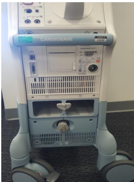
Figura 1: BBIA CARDIOSAVE – Localização do Número da Peça (REF) e Número de Série (SN)
