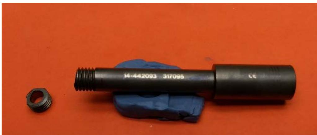
A Zimmer Biomet está conduzindo um recall de dispositivos médicos para lotes específicos do instrumental devido ao produto ter sido fabricado a partir do material incorreto, que mostra uma diminuição potencial na resistência à fadiga da rosca de conexão podendo levar à fratura.
