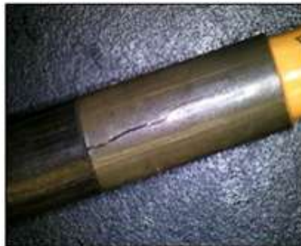
Figura 2. Exemplo de trinca encontrada em instrumentos MCS danificados
