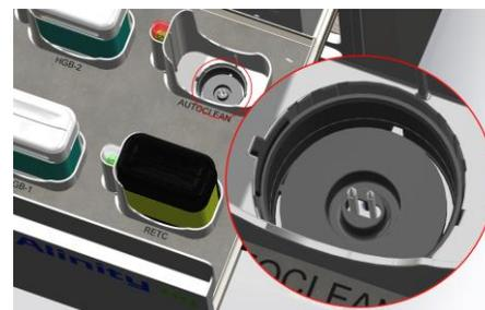
*Desenhos do suporte do frasco da Solução de Autolimpeza Alinity hq exibindo detalhe quando a trava de segurança cobre as probes de perfuração e quando a trava de segurança não é acionada mostrando as probes de perfuração expostas. Todos os suportes de frascos possuem probes de perfuração idênticas.*
