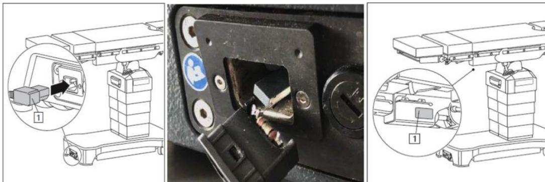
Figura 1: posição da conexão de rede elétrica na Mesa de Operações / conexão de rede desconectada com os componentes eletrônicos expostos / posição da etiqueta do produto na Mesa de Operações Móvel MEERA incluindo SN
