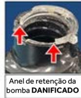
Anel de retenção da bomba **DANIFICADO**
