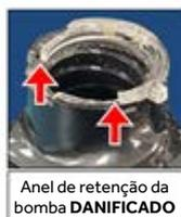
Anel de retenção da bomba **DANIFICADO**
