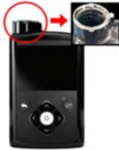
Imagem: Localização do anel de retenção na bomba de insulina da série MiniMed™ 600
