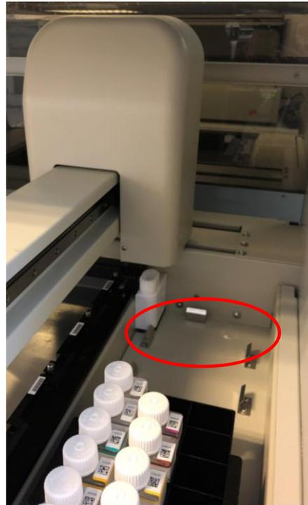
Inspeccione visualmente a área em redor da estação de lavagem, a área destacada a vermelho, quanto a indícios de fugas inesperadas (resíduos de sal e/ou líquido). Isto pode indicar fugas da cabeça Z ou uma pressão demasiado elevada da bomba.
