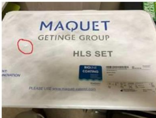
Figura 3: HLS Set - Defeitos no Tyvek
