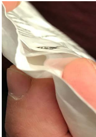
Figura 1: Uma vedação totalmente comprometida
