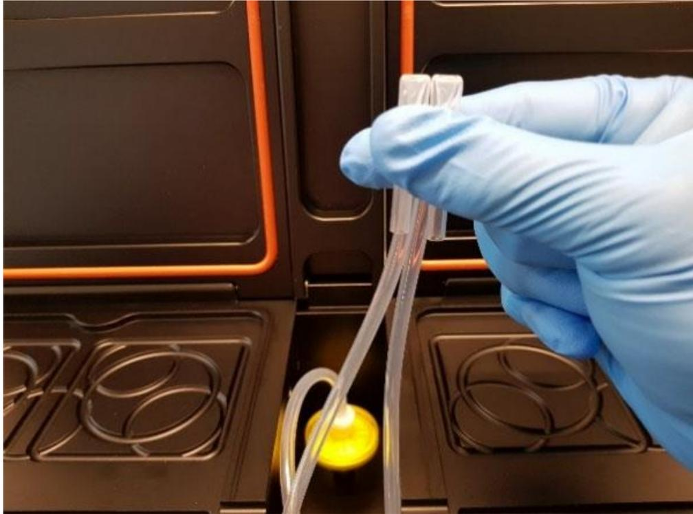
**Figura 2:** Teste de vazamento: mangueiras bloqueadas.
