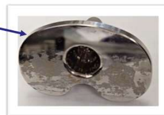
Imagem 2: Exemplo de material residual na superfície do implante
