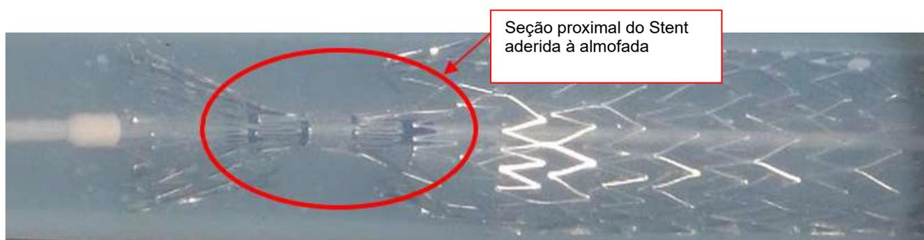
*Figura 1: A extremidade proximal do stent permanece conectada ao material da almofada do stent.*
