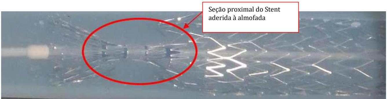
Figura 2: A extremidade proximal do stent permanece conectada ao material da almofada do stent.
