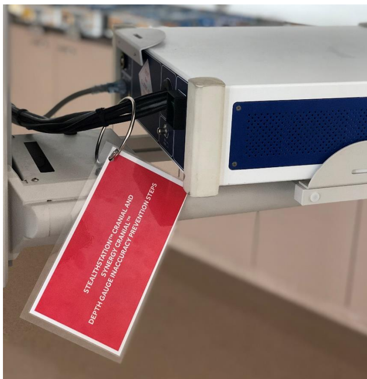
Figura 3. Colocação de placa para o StealthStation™ i7 (conjunto de cabos)
