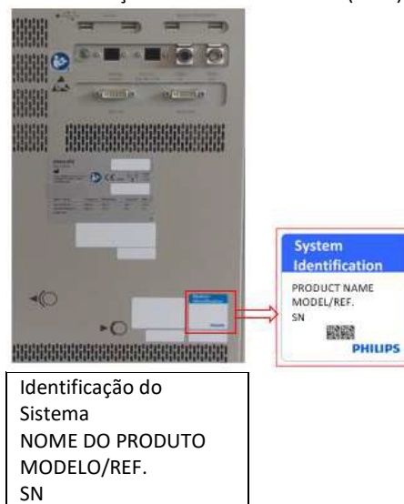
Imagem 1 – Lado Traseiro da Mobile View Station com localização da etiqueta
