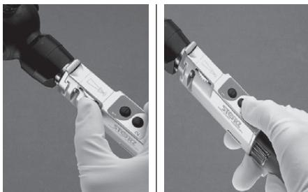
Pour les fibroscopes DCI®, la mise au point se fait au niveau de la molette de réglage de la caméra DCI®.
