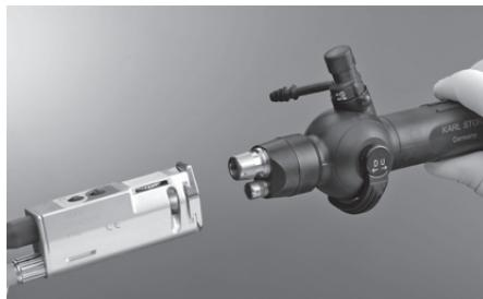
Insira o fibroscópio DCI® até engatar na cabeça da câmara DCI®.
