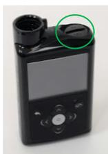
A tampa da bateria pode ser encontrada na parte superior da bomba onde o compartimento da bateria AA está localizado
