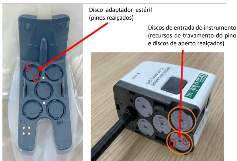
Figura 1 Aplicador de Clip da Vinci X/Xi. Disco adaptador estéril com pinos realçados (esquerda). Discos de entrada de instrumento com recursos de travamento de pino e discos de aperto realçados (Direita).
