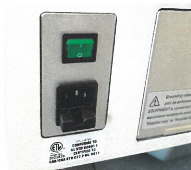
b) Módulo de entrada de energia OHX original com caixa de fusíveis e fusíveis 10 A
