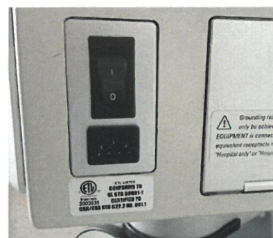
c) Módulo de entrada de energia OHX aprimorado com disjuntores de 12 A
