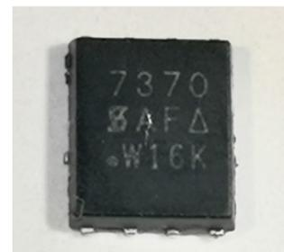
Figura 2: Componente que apresenta falha
