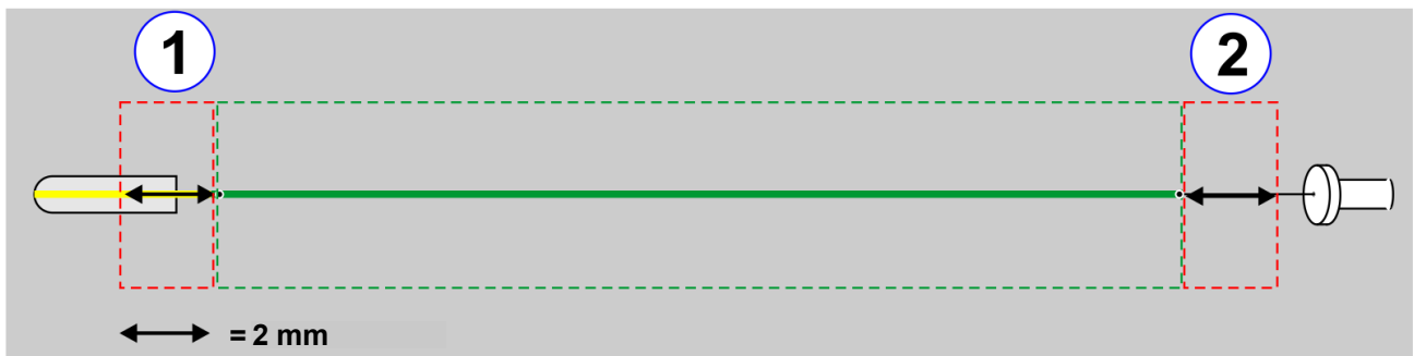
Figura 2. Margens ao redor do cateter reconstruído. A linha tracejada verde indica a margem de 2 mm ao redor do cateter. As margens errôneas são mostradas como linhas tracejadas vermelhas, na extremidade da ponta (1) e na extremidade do conector (2).
