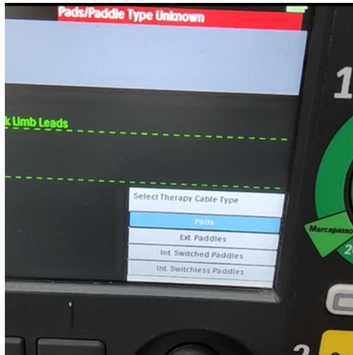
Figura 1: Exibição em tela do DFM100 com problema de identificação incorreta das pás.
