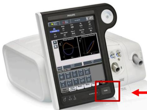
Figura 1: Identificação do ventilador V680 (o botão mostrará V680)
