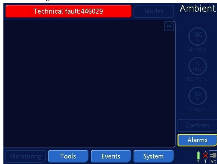
Figura 1: O mostrador indica “Ambient State”, e uma mensagem vermelha com o número da falha técnica (exemplo, uma Falha Técnica diferente pode ser mostrada)
