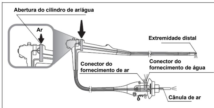
4. Forneça ar comprimido filtrado a uma pressão de 0,2–0,5 MPa na entrada auxiliar de água até que não saia mais álcool nem água da extremidade distal do endoscópio. Forneça ar comprimido por no mínimo 3 minutos para álcool e por no mínimo 90 segundos para água.
