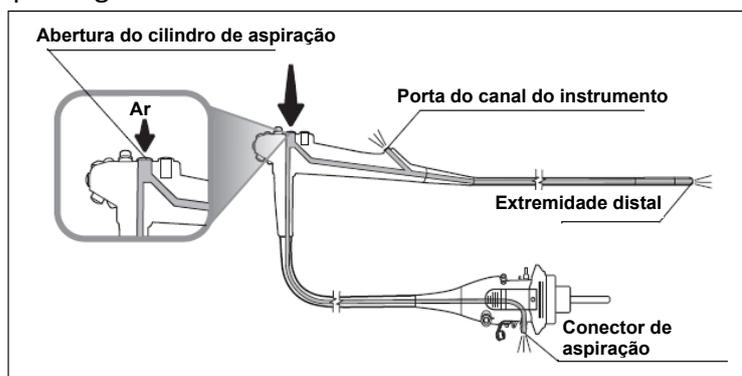
3. Forneça ar comprimido filtrado a uma pressão de 0,2–0,5 MPa na abertura do cilindro de ar/água até que não saia mais álcool nem água da extremidade distal, do conector do fornecimento de ar, do conector do fornecimento de água e da cânula de ar do endoscópio. Forneça ar comprimido por no mínimo 3 minutos para álcool e por no mínimo 90 segundos para água.
