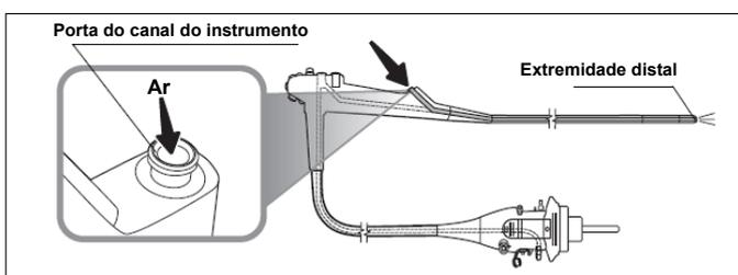
6. Seque cuidadosamente o interior do cilindro de aspiração, o cilindro de ar/água e a porta do canal do instrumento do endoscópio usando cotonetes de algodão estéreis.
