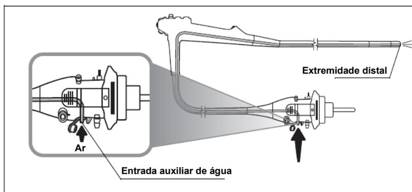
5. Forneça ar comprimido filtrado a uma pressão de 0,2–0,5 MPa na porta do canal do instrumento até que não saia mais álcool nem água da extremidade distal do endoscópio. Forneça ar comprimido por no mínimo 3 minutos para álcool e por no mínimo 90 segundos para água.
