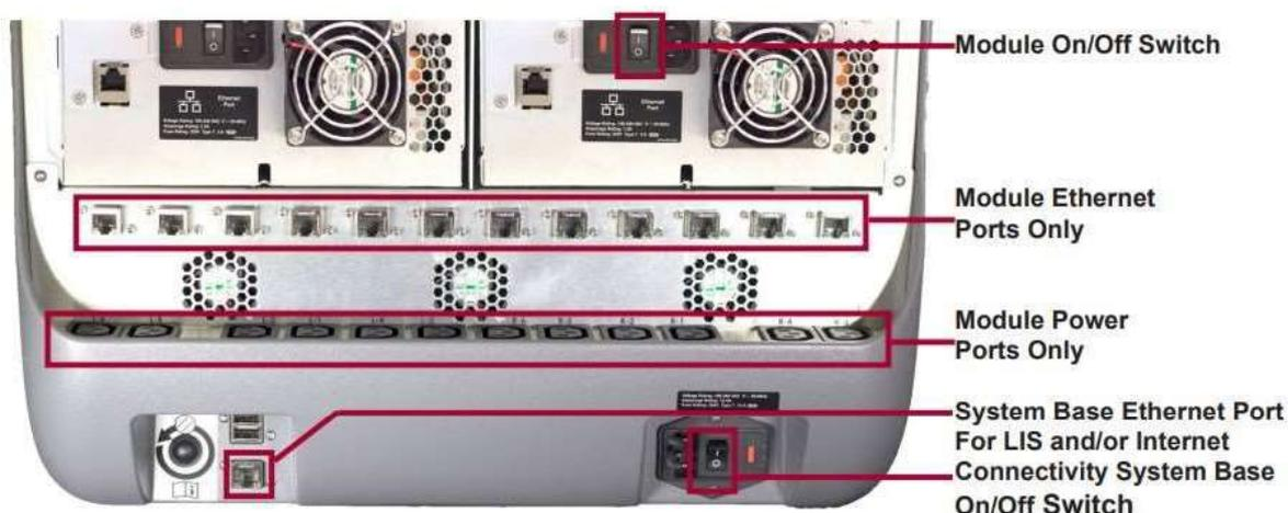
Depois que a Base do Sistema foi ligada, então cada Módulo conectado podem ser ligados as coberturas dos cabos, instaladas.
