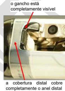
Figura 3: Verificação do acoplamento total
