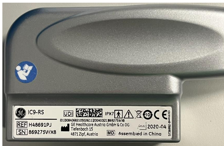
Figura 4. Exemplo de placa de identificação - exibindo o tipo de sonda (IC9-RS) e o número de série (SN).
