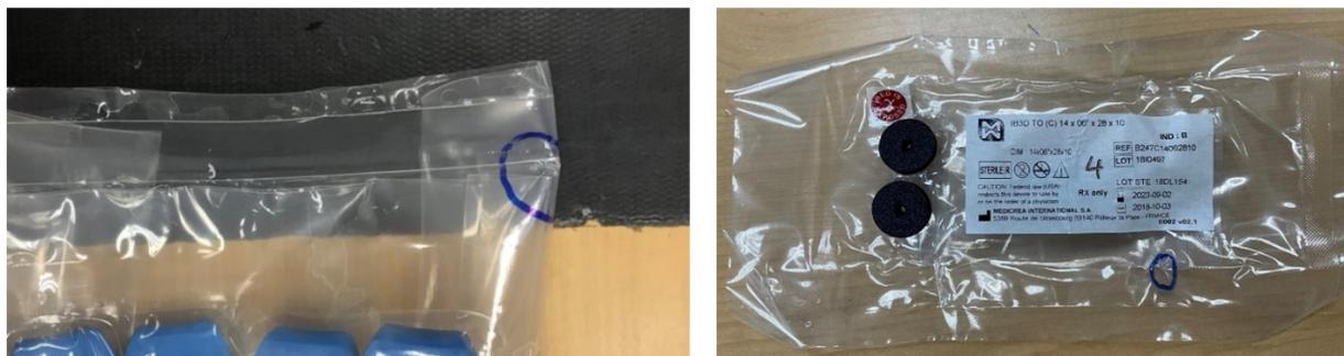
Figure 1: Fotos de vazamentos identificados na barreira estéril (circulados no marcador)
