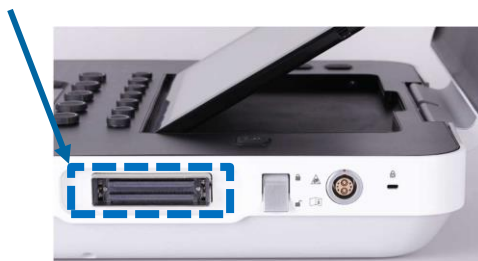
Figura 3. Porta na lateral para conexão direta do transdutor
