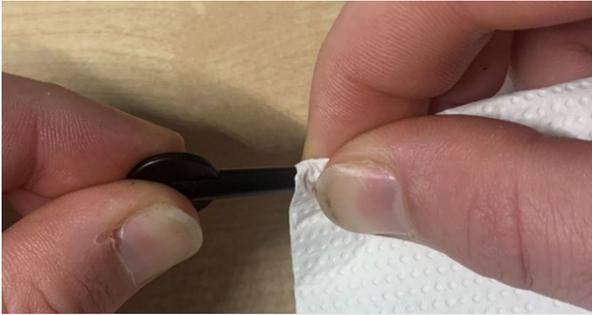
**Fig. 7 - Posição do pano de fibra quando segurando o tubo LDPE (852652)**
