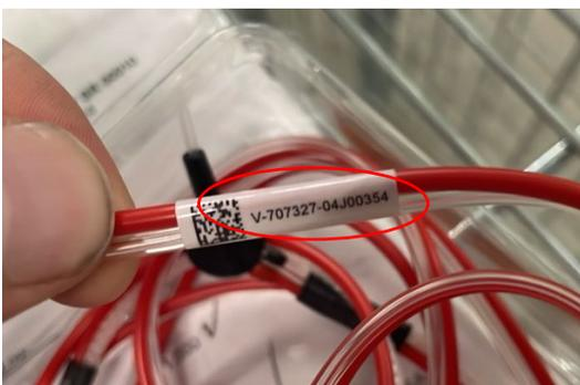
Exemplo de etiqueta no dispositivo Twin Tube sample line 240 cm (P/N: V-707327) com **número de série** circulo.
