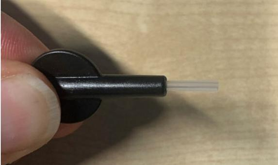
**Fig. 10 - Tubo LDPE de ajuste apertado**
