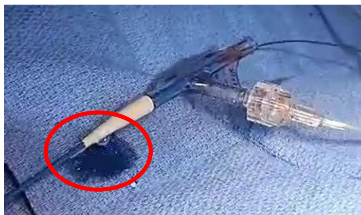
Figura 1: Local de vazamento no hub do cateter Ultraverse 035.
