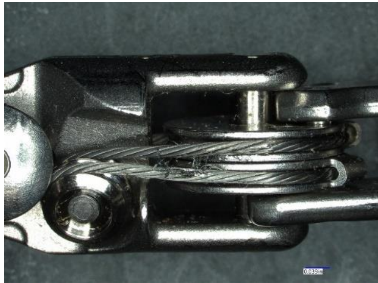
Figura D: Ampliação de 20x de um cabo de pega desgastado em um instrumento da Vinci Xi.
