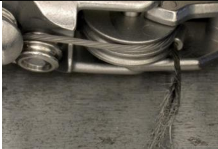
Figura C: Ampliação de 20x de um cabo de pega rompido em um instrumento da Vinci Xi.
