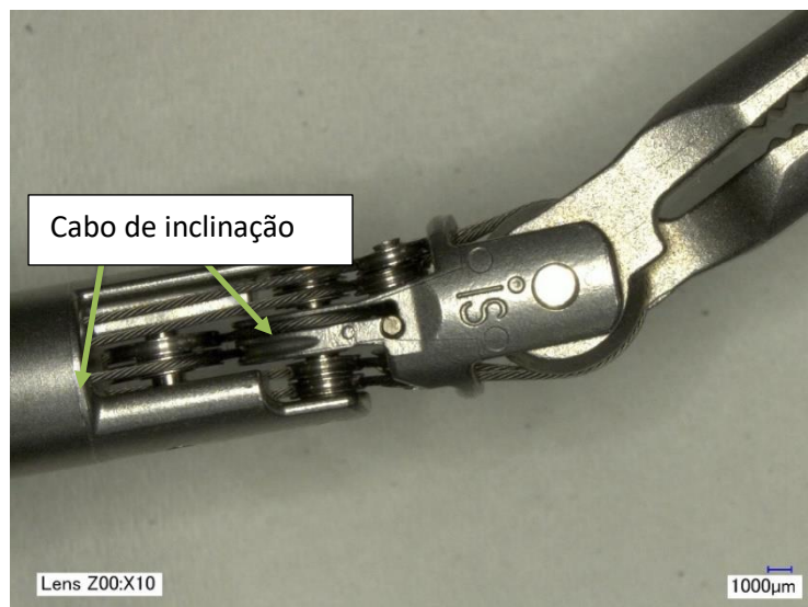
Figura B: Exemplo ampliado 10x de um cabo de inclinação intacto em um instrumento Small Graptor da Vinci Xi.
