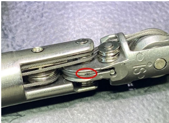
Figura G: Cabo de inclinação desgastado
