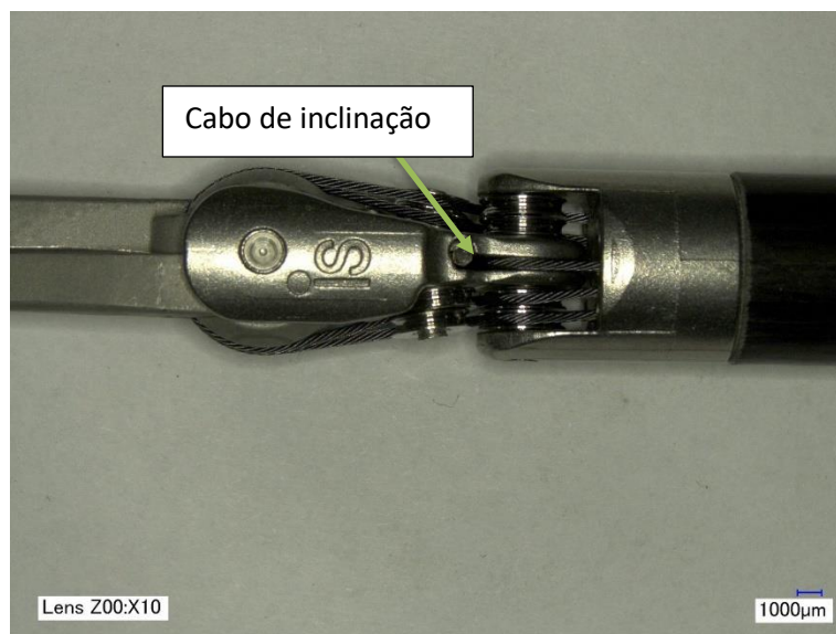
Figura A: Exemplo ampliado 10x de um cabo de inclinação intacto em um instrumento Pinça Tenaculum da Vinci Xi.
