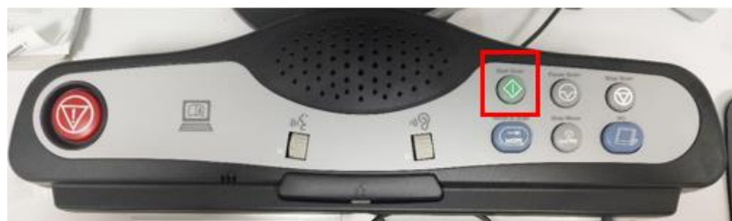
Figura 1. Módulo de Interface de Controle de Varredura (SCIM) mostrando o botão “Start Scan” (Iniciar varredura) iluminado.
