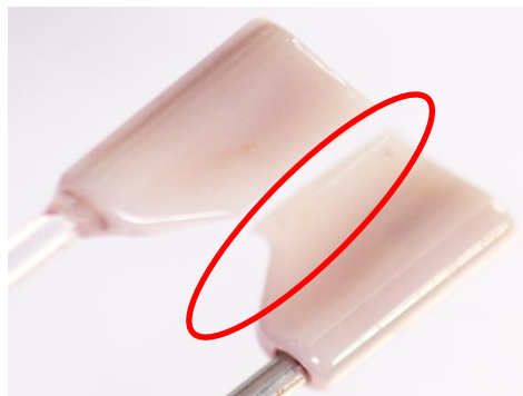
Anel C não conforme (anel C dividido)
