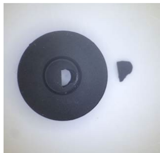
Figura 1: Desprendimento de fragmento da fenda da MAJ-210.
