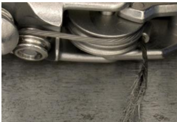
Figura C: Ampliação de 20x de um cabo de pega rompido em um instrumento da Vinci Si
