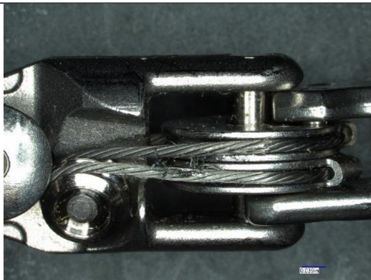
Figura D: Ampliação de 20x de um cabo de pega desgastado em um instrumento da Vinci Si
